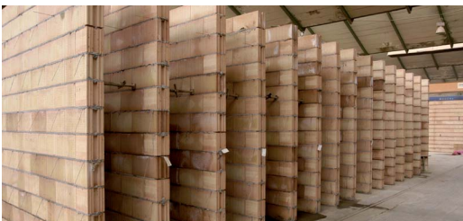
Abb. 9: Produktion von Ziegelfertigelementen Bildquelle: Bundesverband der Deutschen Ziegelindustrie, Bonn
