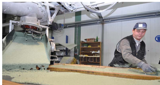
Abb. 7: Herstellung von Betonfertigteilen Bildquelle: © BetonBild
