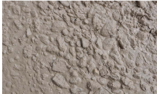
Abb. 13: Faserbeton roh - zur Verbesserung der Zugfestigkeit werden Fasern zugegeben, die als Bewehrung wirken. Bildquelle: © BetonBild
