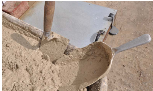
Abb. 14: Faserbeton roh - zur Verbesserung der Zugfestigkeit werden Fasern zugegeben, die als Bewehrung wirken. Bildquelle: © BetonBild
