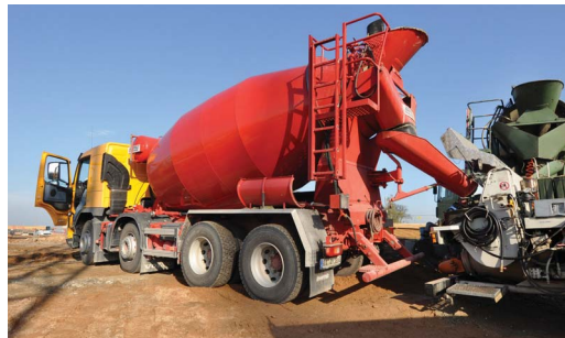
Abb. 10: Anlieferung von Transportbeton in einem Mischfahrzeug.
