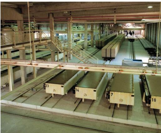
Abb. 5: Porenbeton Rohblöcke in der Gussform
