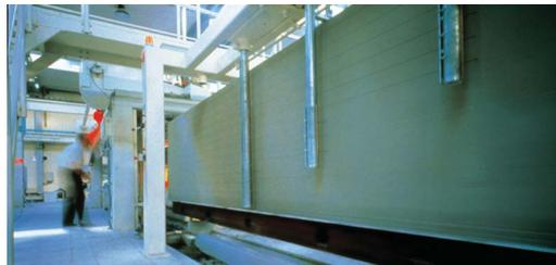
Abb. 6: Porenbeton Rohblöcke in der automatischen Schneideanlage
