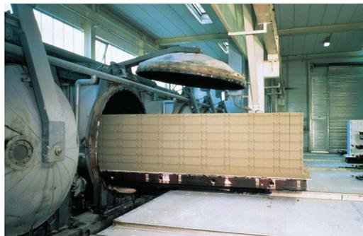
Abb. 7: Die Härtung der Porenbeton Rohblöcke erfolgt im Autoklaven bei Temperaturen von 180 bis 200 ° C
