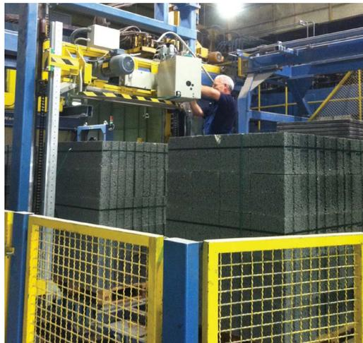
Abb. 1: Nach ca. 24 bis 36 Stunden sind sie so fest, dass sie mechanisch palettiert gebunden und gestapelt werden können.
