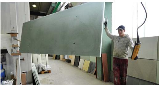
Abb. 3: Wandelemente aus Beton im Werk.
