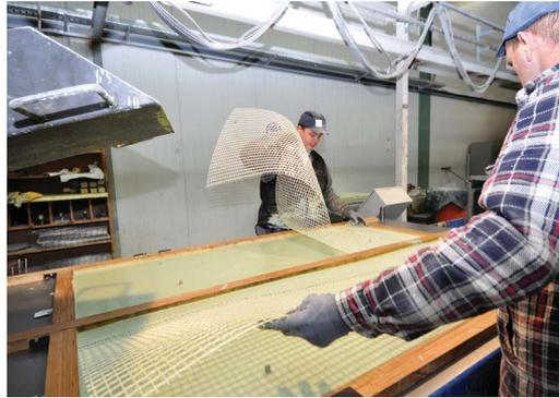
Abb. 2: Betonfertigteile für die Außenwandkonstruktionen werden witterungsunabhängig im Werk unter idealen Bedingungen und konstanter Überwachung des Produktionsprozesses jeweils entsprechend der individuellen Abmessungen der Gebäude hergestellt. Bildquelle: © BetonBild
