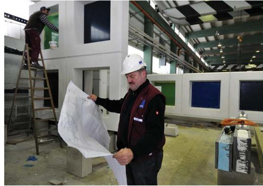
Abb. 5: Die Beton-Fertigelemente werden im Werk beliebigen Formen und Größen produziert und auf der Baustelle montiert.
