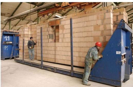
Abb. 2: Mauertafeln aus Ziegeln sind vorgefertigte Mauerwerkselemente, die entsprechend der individuellen Planung im Werk exakt nach Maß gefertigt werden.
