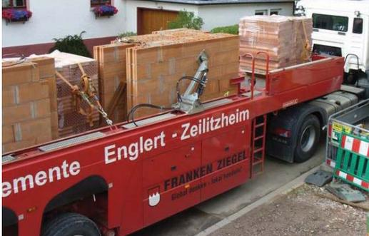
Abb. 3: Die Elemente werden entsprechend dem Terminplan just-in-time angeliefert. Der Transport erfolgt aufrecht stehend per LKW oder mit Spezialtransportfahrzeugen, die nach den Vorgaben des Montageplans bestückt werden.
