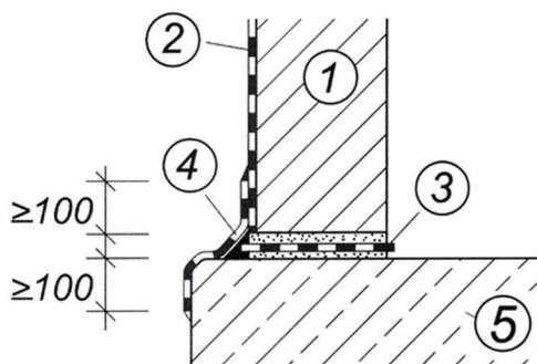
Abb. 6: Abdichtung gegen aufstauendes Sickerwasser mit WU-Bodenplatte
