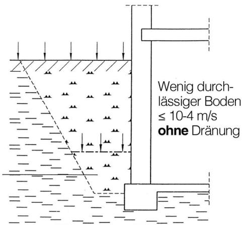
Abb. 2: Aufstauendes Sickerwasser
