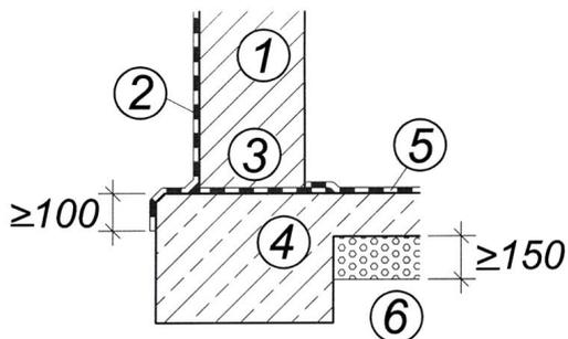
Abb. 4: Abdichtung gegen Bodenfeuchte oder nichtstauendes Sickerwasser
