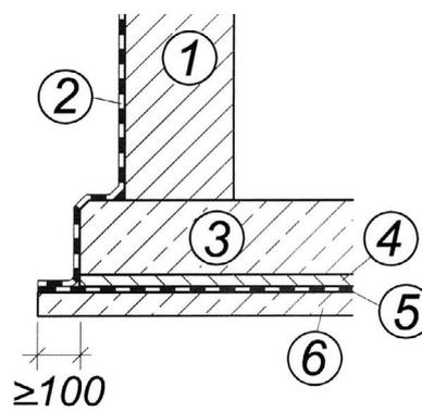
Abb. 5: Abdichtung gegen aufstauendes Sickerwasser mit wannenartiger Abdichtungshaut
