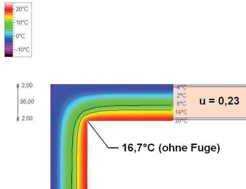
Abb. 1: Geometrische und baustoffbezogene Kennwerte der Wand und Temperaturverlauf in einer Gebäudeecke (ohne Montagefuge)
