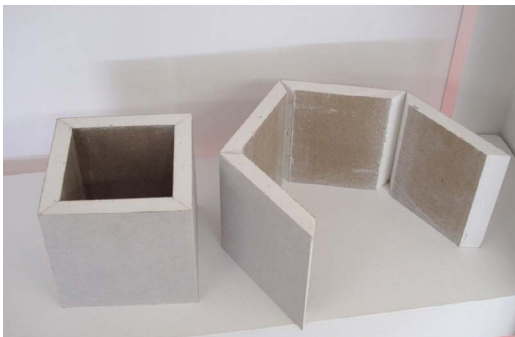
Abb. 10: So lassen sich Gipsplatten passgenau knicken und falten.
