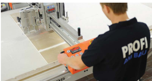
Abb. 11: Die Fräsungen können auf speziellen Frästischen hergestellt werden.
