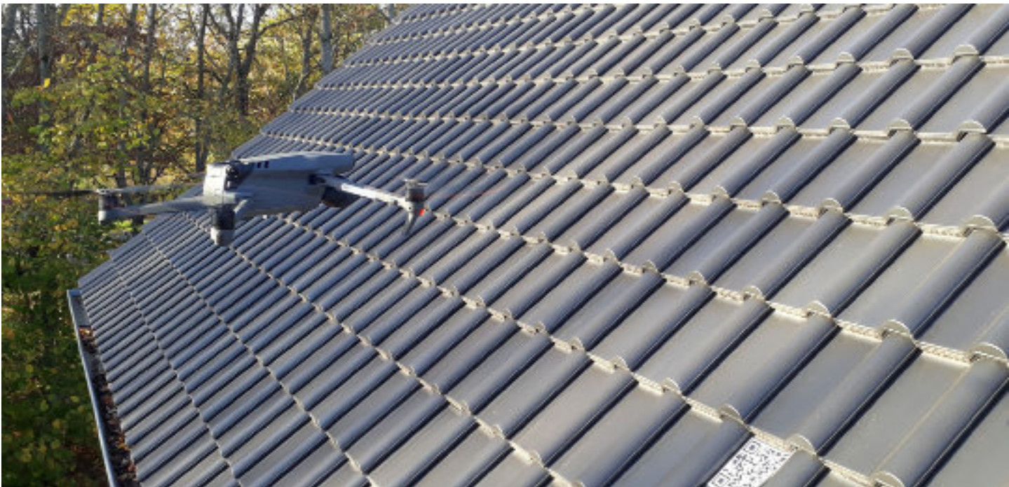
Suche einer Schadstelle – hier simuliert durch QR-Code – mithilfe einer Drohne (Bild: Bubiza)
